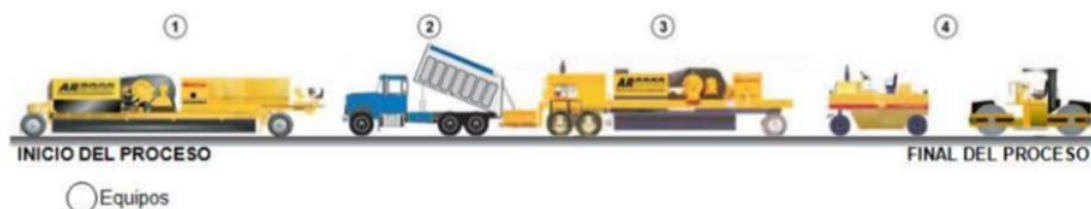
Figura 5.4: Proceso para reciclado de RAP In situ Caliente
