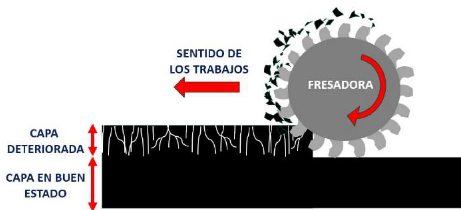
Figura 4.3: Fresado de pavimento asfáltico
