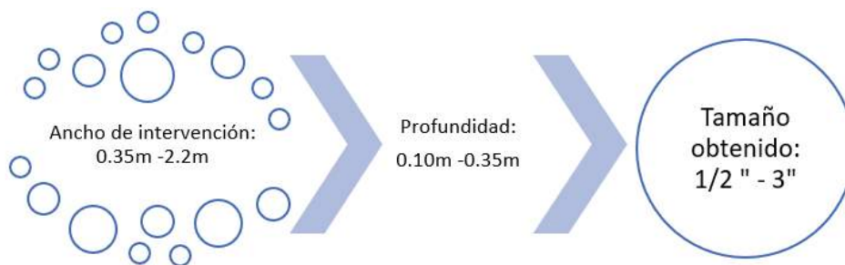
Figura 4.5: Características proceso de fresado
