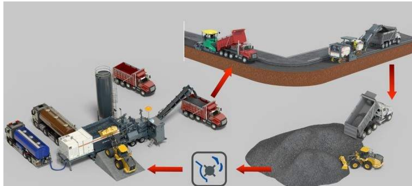
Figura 5.6: Proceso de capas estabilizadas con cemento asfáltico
