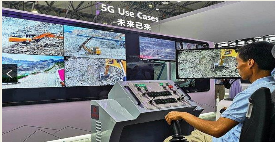
Remote Excavation 5G 远程操作挖掘机
